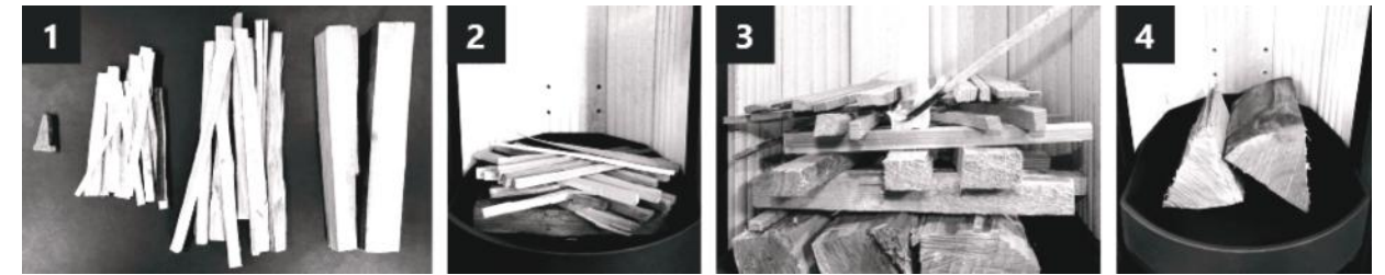
Obr. 4 Postup prípravy dreva v spaľovacej komore
