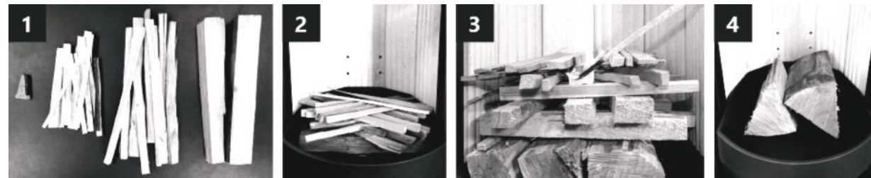
Рис. 4 Процедура подготовки древесины в камере сгорания
