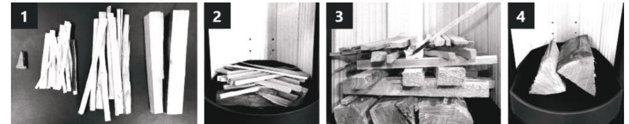
Kép 4. A fa előkészítési eljárása az égetőkamrában
