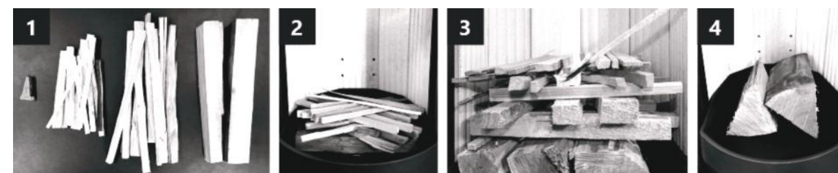
Rys. 4 Procedura przygotowania drewna w komorze spalania
