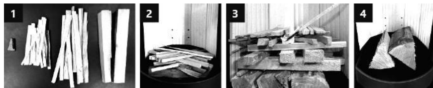
Obr. 4 Postup prípravy dreva v spaľovacej komore
