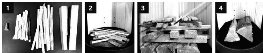
Kép 4. A fa előkészítési eljárása az égetőkamrában
