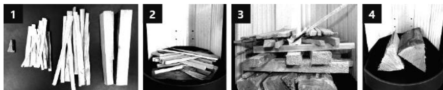
Obr. 4 Postup přípravy dřeva ve spalovací komoře
