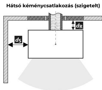
A füstcső áthaladása éghető anyagból készült falon
