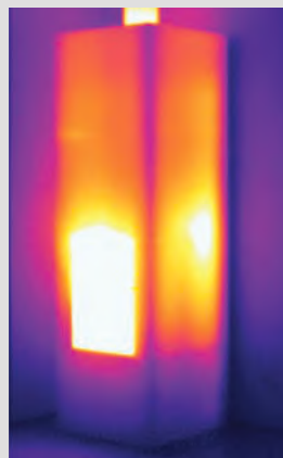
3 hod. od zatopení Průměrná teplota povrchu 88 °C
