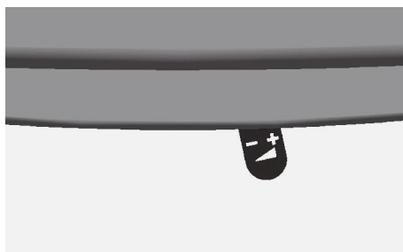
Obr. 4.8 Šoupátko spalovacího vzduchu posunutě úplně doprava – přívod spalovacího vzduchu je úplně otevřený
