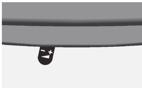
Obr. 4.7 Šoupátko spalovacího vzduchu posunutě úplně doleva – přívod spalovacího vzduchu je úplně zavřený
