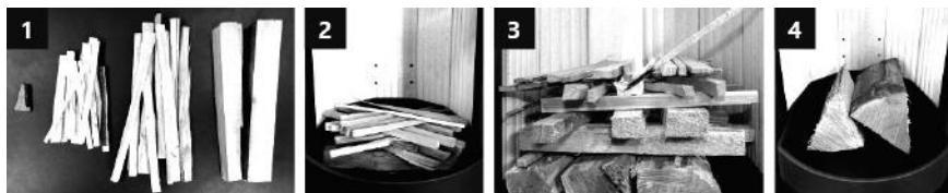
Obr. 4 Postup prípravy dreva v spaľovacej komore
