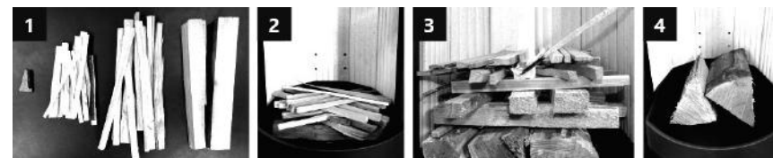
Rys. 4 Procedura przygotowania drewna w komorze spalania
