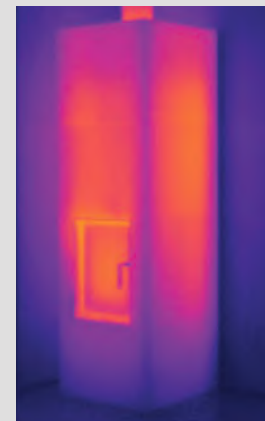
12 hod. od zatopení Průměrná teplota povrchu 45 °C
